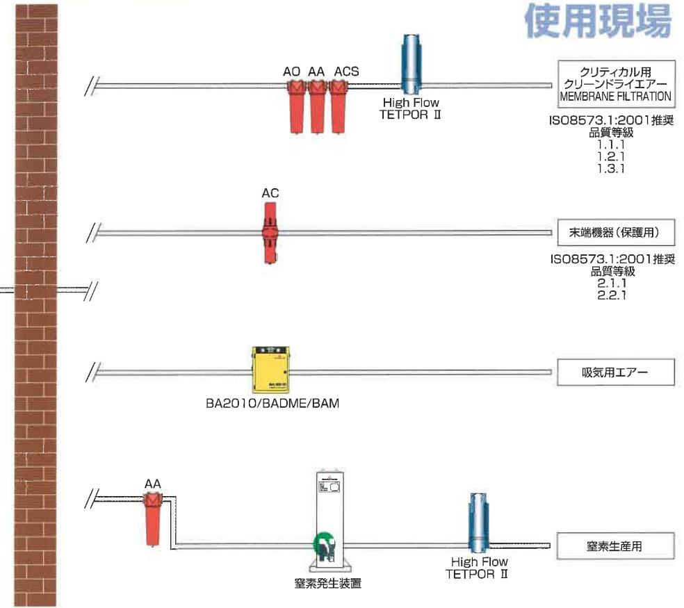
ドムニクハンターでは様々な圧縮空気用浄化装置を取り揃えており、お客様の各末端で要求されている空気品質に応じた製品を提供することができます。
